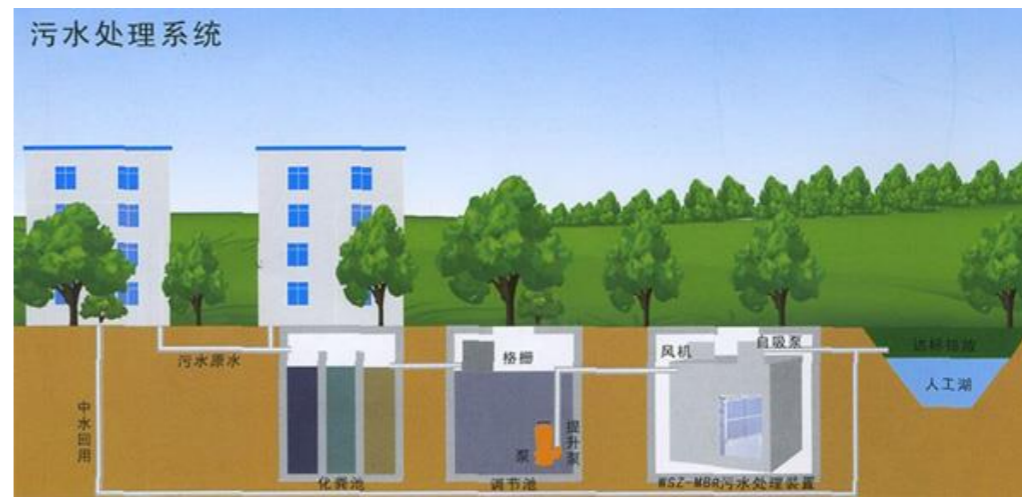
图 7-1 居住区再生水利用示意图
