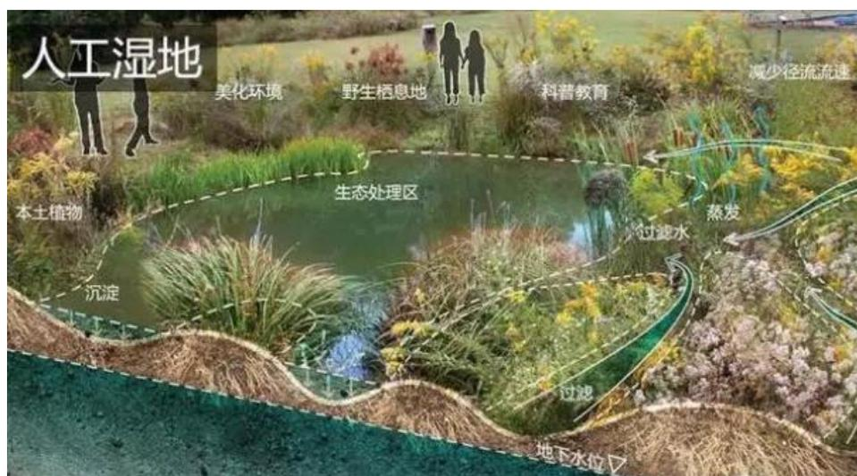
图 4.2-17 雨水湿地构造示意图
