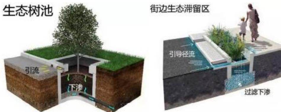
图 4.2-11 生态树池和街边生态滞留区构造示意图
