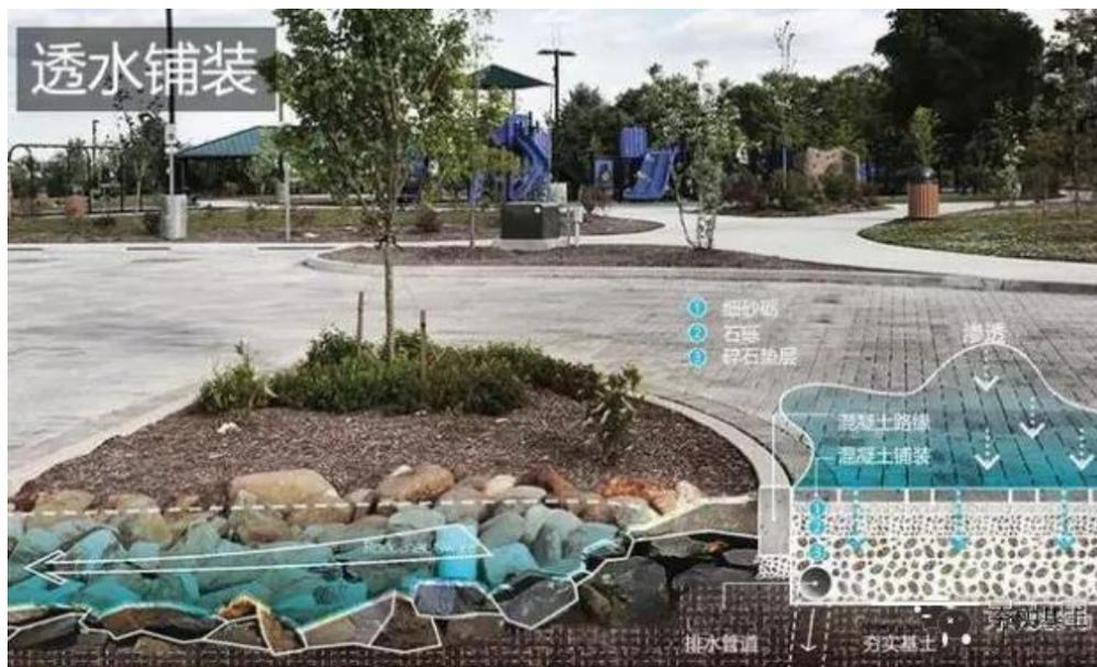
图4.2-4 透水砖铺装典型结构示意图
