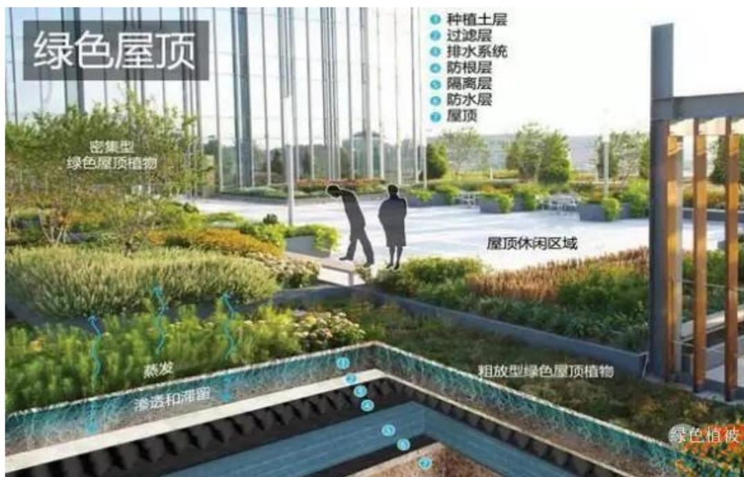
图 4.2-6 绿色屋顶典型构造示意图
