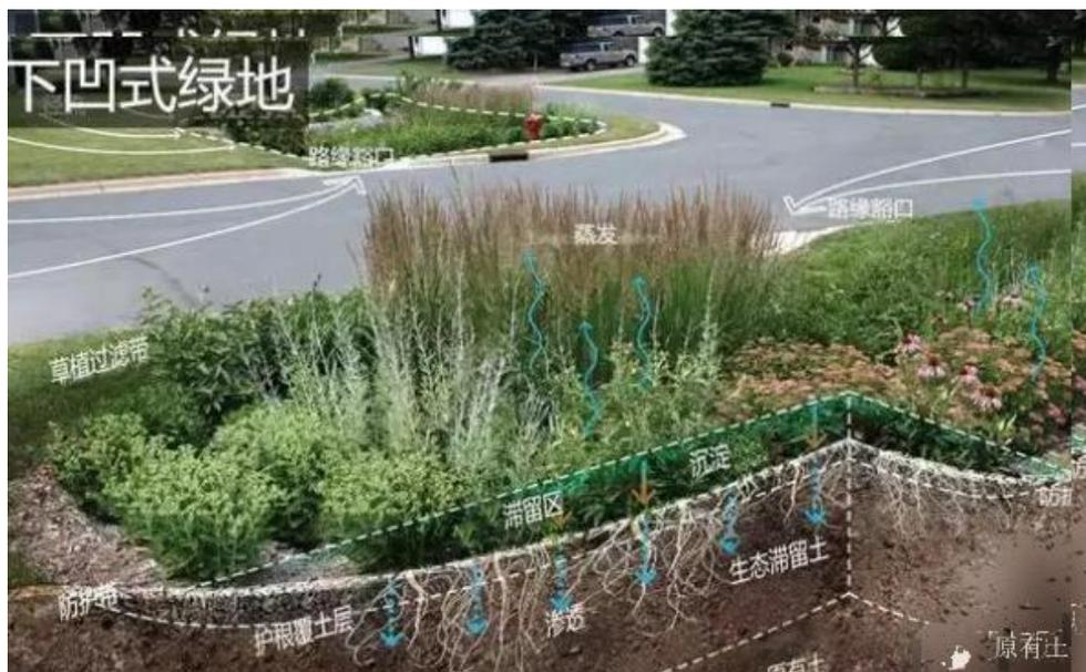
图 4.2-8 狭义的下沉式绿地典型构造示意图
