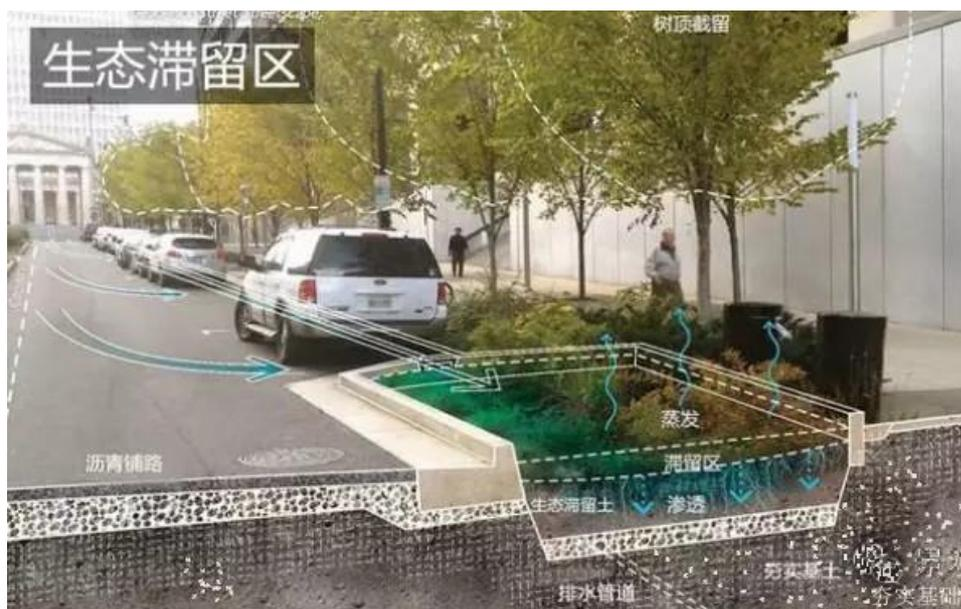
图 4.2-10 生态滞留区构造示意图
