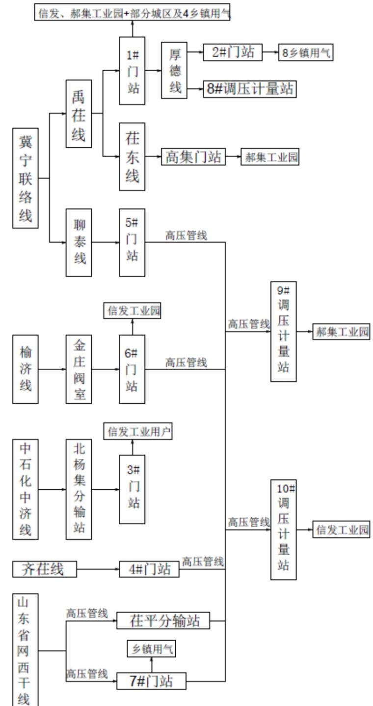
图4-1 茌平区天然气输配方案系统框图
